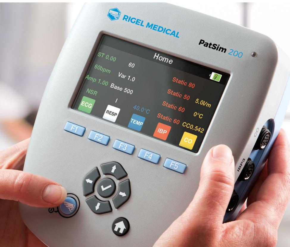
Rigel推出的PatSim200模拟器采用全新设计,实现了更快更高效的患者信号模拟。与其它同类型模拟器不同的是,PatSim使用Home键及调用功能实现测试功能和最常使用序列间的切换,执行测试时无需多次点击和在“树形”等级之间来回滚动菜单。
